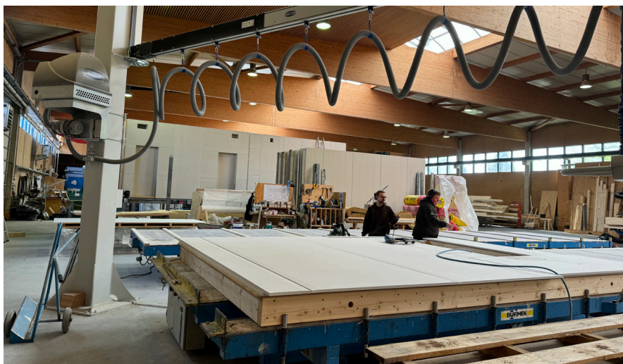
Holzrahmenbauproduktion für hochfeuerhemmende Elemente. Foto: Kathe
